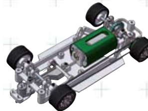
Motor longitudinal con poleas Inline motor with belts
