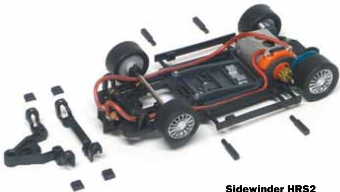
Sidewinder HRS2 Ready to run HRS2 chassis OFFSET 0,5mm
